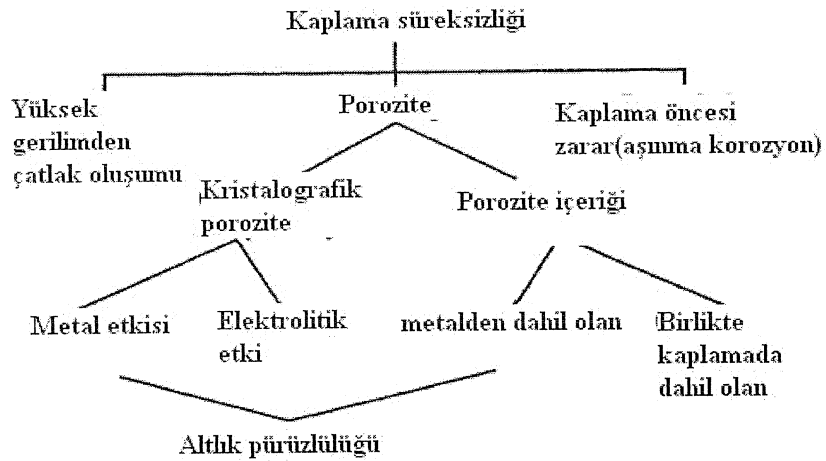
Şekil 2.7. Elektrolitik kaplamada süreksizliklerin nedenleri [15]
