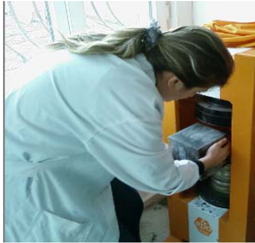
Şekil 6.10. Beton Numunelerinin Pres makinesına Yerleştirilmesi
