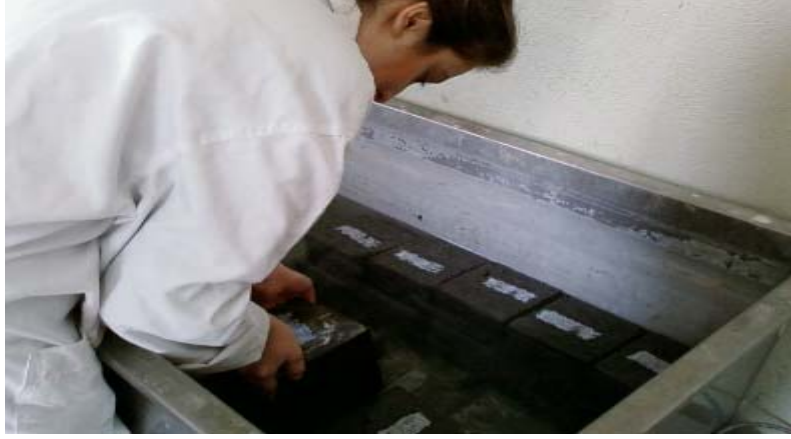
Şekil 6.8. Beton Numunelerinin Kür Havuzuna Yerleştirilmesi
