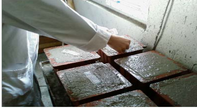
Şekil 6.7. Beton Karışımının Kalıplara Yerleştirilmesi
