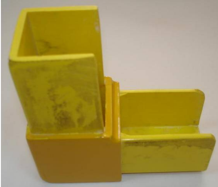
Şekil 4.14. Yapıştırırmalı-geçmeli birleřtirmelerde kullanılan CTP birleřtirme elemanı [18]
