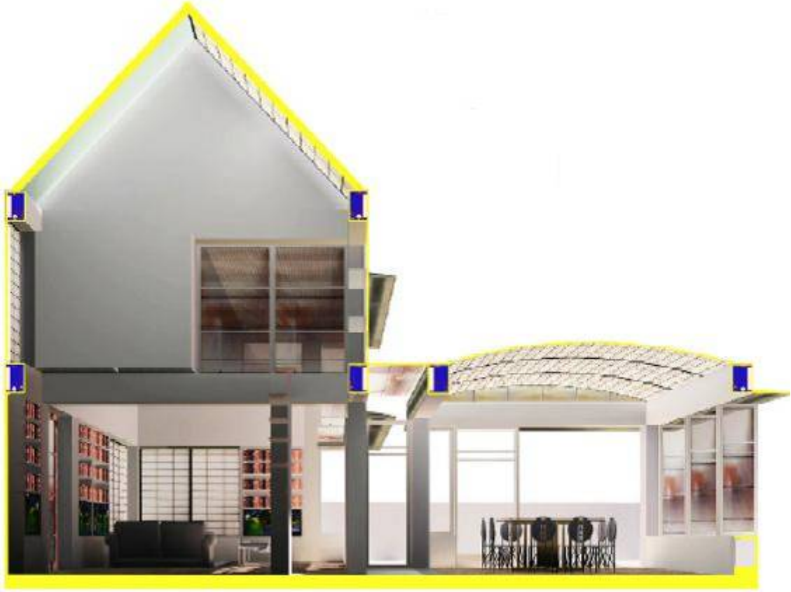
Şekil 3.21. Pultrüzyonla üretilmiş CTP kullanılarak yapılmış prototip yapı
