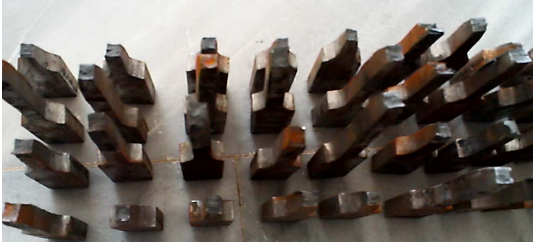
Şekil 8.15. Çekme testi sonrasında oluşan kırılmalarda sünek kopma biçimleri
