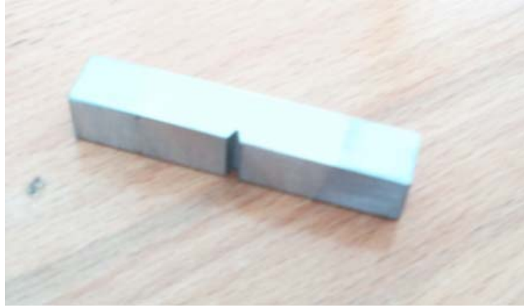
Şekil 7.8. TS EN 10045-1 standardına göre hazırlanmış çentik darbe test parçası
