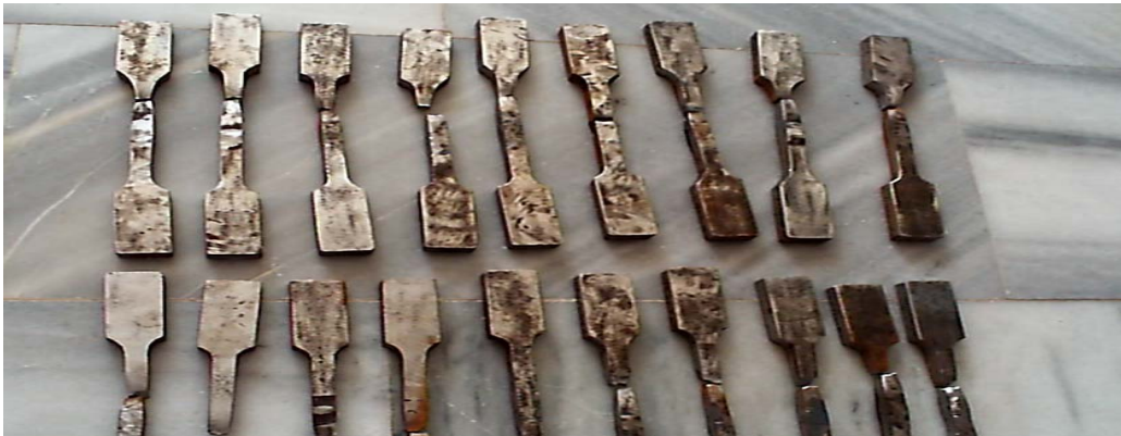
Şekil 8.14. Çekme deneyi sonrasında test parçalarının biçimleri
