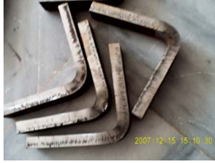
Şekil 8.18. Eğme testi sonrası test parçalarının şekilleri
