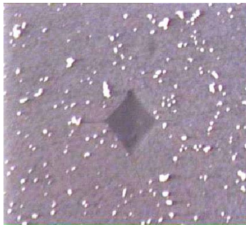
Şekil 6.5. 10 kg yük uygulanması sonucu kompozitte oluşan çatlaklara partikül takviyesinin etkisi
