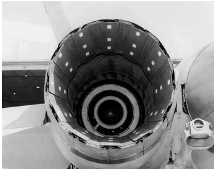
Şekil 2.9. F18 uçağının F414 motoruna ait 12 parça SMK kanatçık ve sızdırmaz kapaklı egzoz borusu. Sızdırmaz alanlar üzerindeki beyaz bölgeler mekanik bağlayıcılar için ilave \text{ZrO}_2 kaplanmadır [7].
