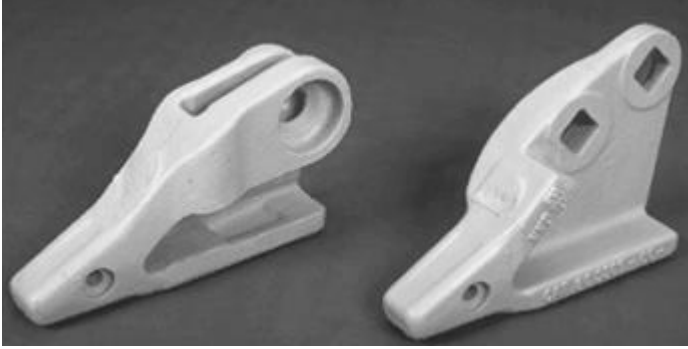
Şekil 4.33. Bekoloder tipi iş makinelerine takılan uç tipleri [22]
