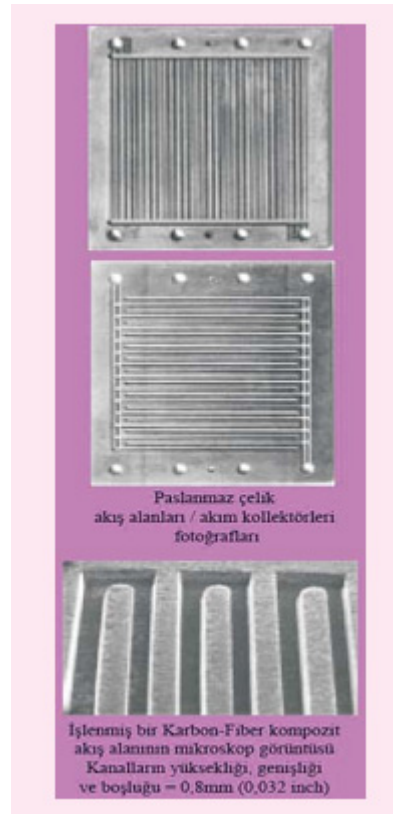
Şekil 4.10. Akış Alanları ve Akım Kolektörlerinin Detaylı Görünümü
