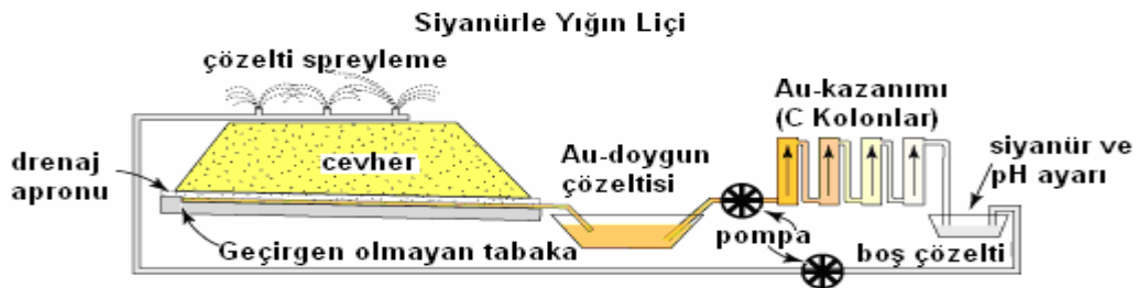
Şekil 4.2. Yıgın liçi ile altın kazanımının şematik gösterimi [41].
