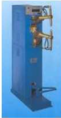
Şekil 2.34. Mekanik elektrik direnç nokta kaynak makinesi (Mekanik ayak pedallı ve merkezi su soğutma sistemine sahip model olup max. 5+5 mm parça kalınlığına kadar kaynak yapabilir.)
