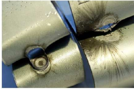
Şekil 2.30. Nokta kaynağında düğmelenme yoluyla hasar
