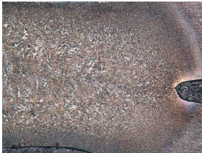
Şekil 6.5. 1,0 mm - 1,2 mm kalınlıktaki numunelerde 8 kA, 10 periyot kaynak parametresinde kaynak çekirdeği çevresinde simetrik çekirdek geometrisinin bozulması (x50)
