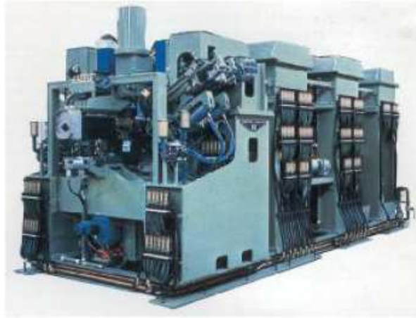
řekil 2.39 Özel tasarımı tam otomatik elektrik direnç nokta kaynak makinesi(Otomobil fabrikalarında kaporta seri üretiminde kullanılır)
