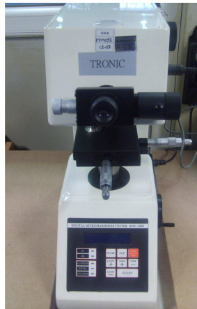
Şekil 4.12. Mikrosertlik ölçümünde kullanılan vickers ölçüm cihazı (TRONIC)
