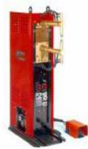
Şekil 2.35. Pnömatik elektrik direnç nokta kaynak makinesi ( Pnömatik ayak pedallı ve merkezi su soğutma sistemine sahip model olup max. 5+5 mm parça kalınlığına kadar kaynak yapabilir.)
