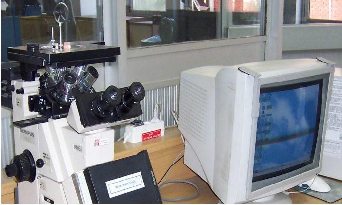
Şekil 4.9. Mikro yapı tespitlerinde kullanılan optik mikroskop ( Olympus PME 3 ).
