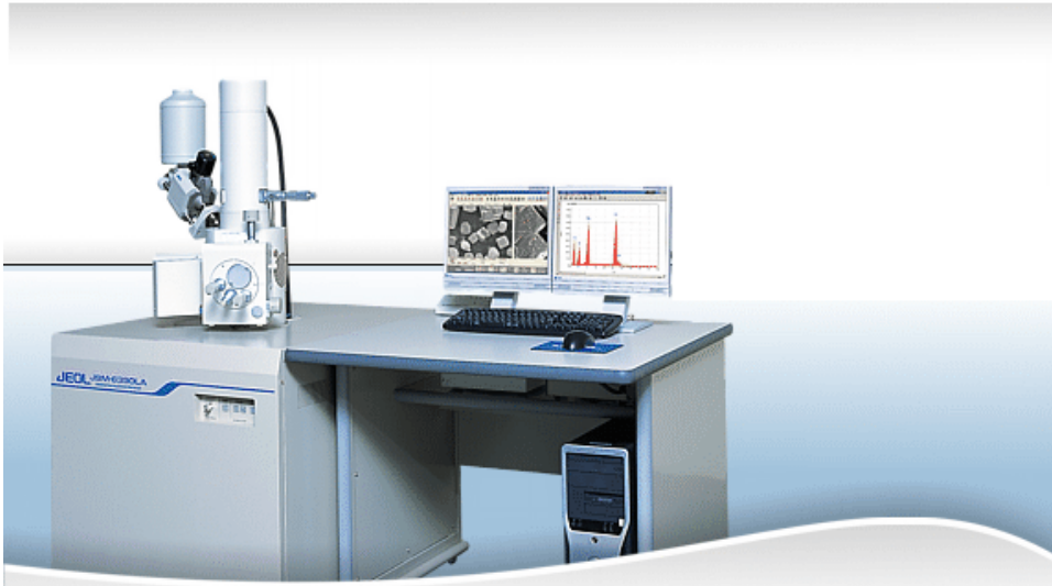
Şekil 4.11. X ışınları çekiminde ve EDS analizinde kullanılan JEOL marka SEM cihazı
