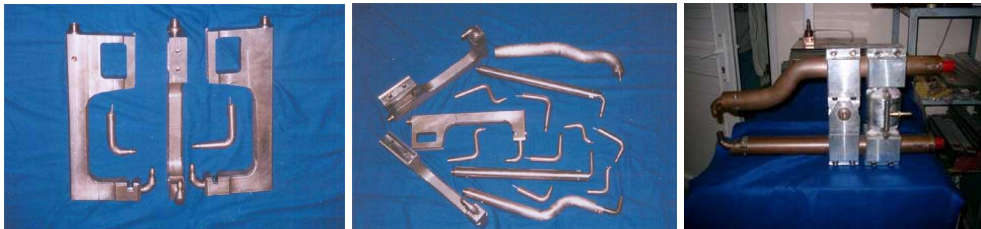
Şekil.2.40 Sektörde kullanılan punta kolları örnekleri[52]
