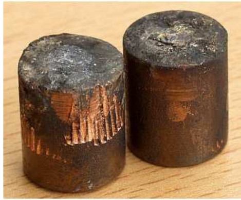
Şekil 2.17. Elektrot uçlarında mantarlaşıma[54]
