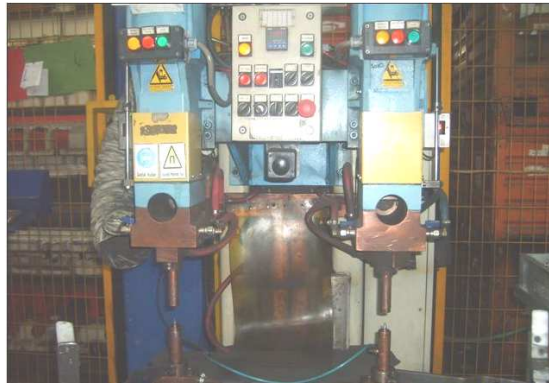
Şekil 4.6. Kaynaklı bağlantıların yapıldığı çift kollu direnç nokta kaynak makinesi
