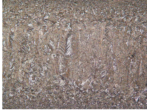
Şekil 6.2.1, 1,0 mm - 1,0 mm sacda 4 kA, 10 periyotta nokta kaynağı yapılmış parçada kaynak bölgesi (x50)
