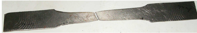
Şekil 5.3. Çekme testi uygulanarak kopan ana malzemenin fotoğrafı
