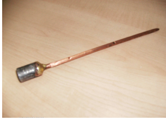
Şekil 3.4. Bağlantı yeri ve bakır çubuk [8]
