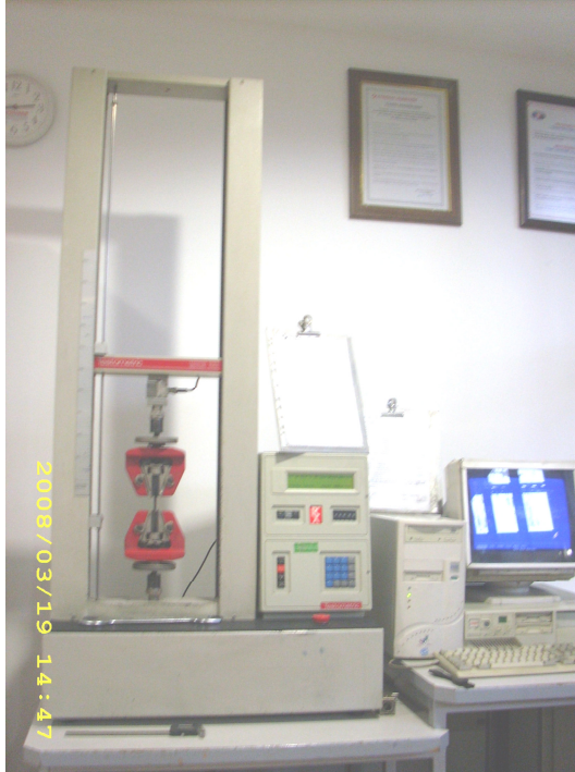
Şekil 5.2. a) Testometric micro 350 PCX çekme test cihazı ve bilgisayar donanımı b) Çekilmiş TS 1398-2 Standart Test Numuneleri
