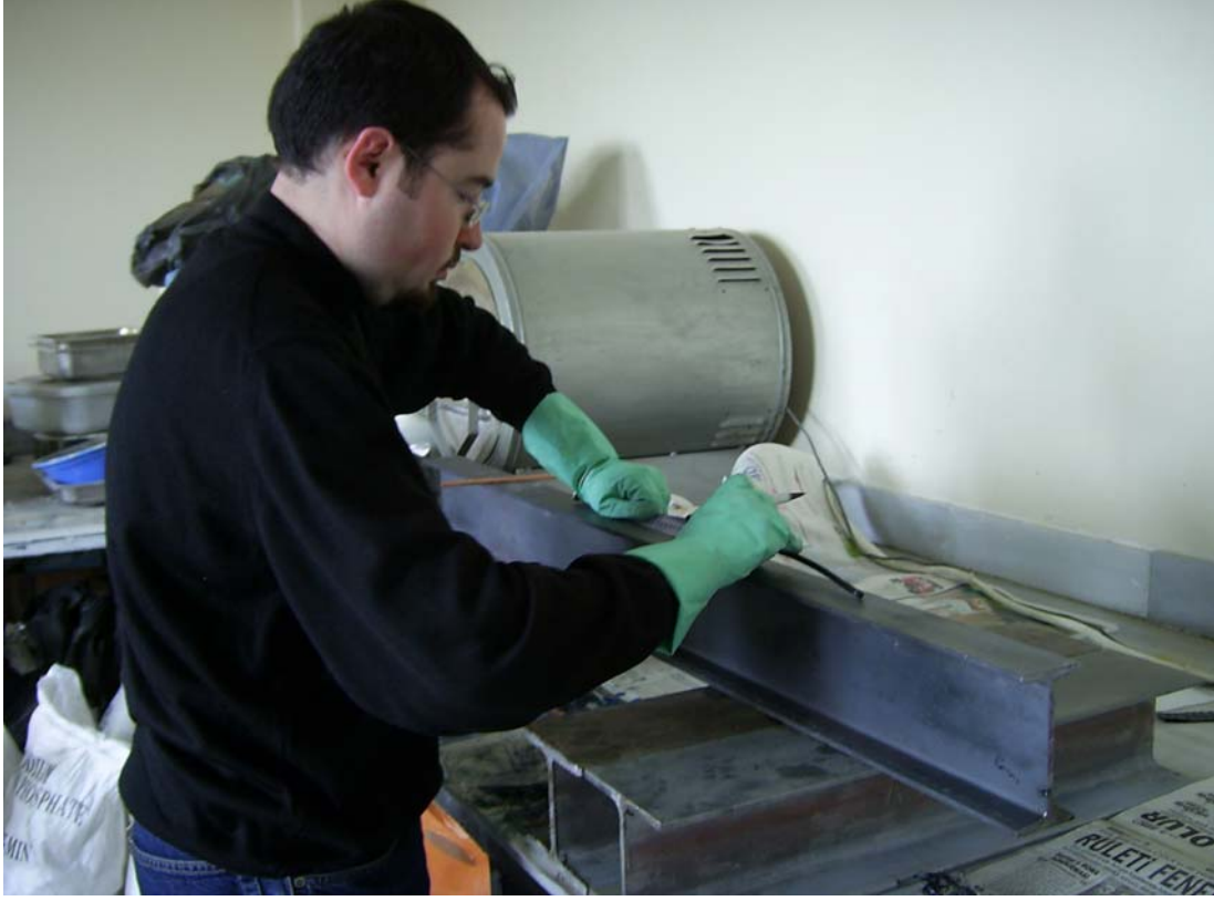
Şekil 3.14. Yapıştırma Alanının Belirlenmesi
