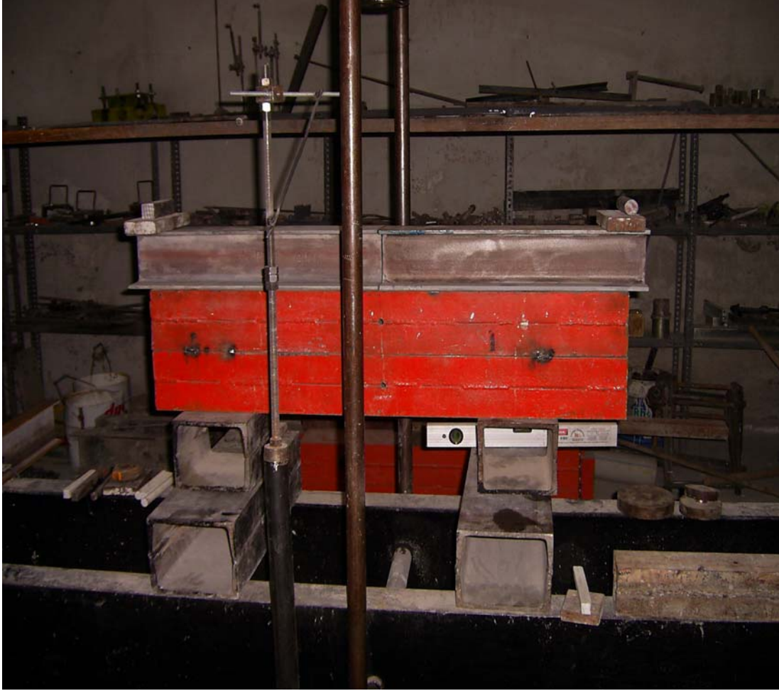
řekil 3.22. Mesnetlerin Yerleřtirilmesi
