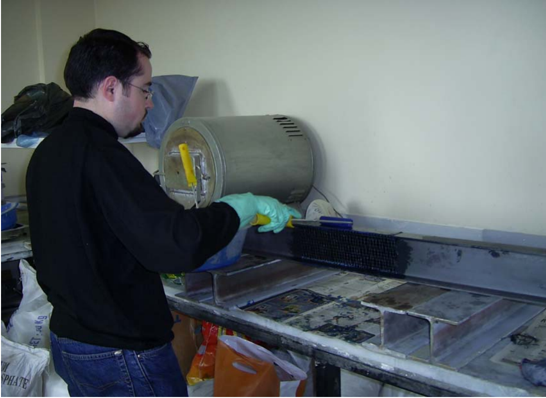
Şekil 3.17. İkinci Kat Yapıştırıcının Sürülmesi
