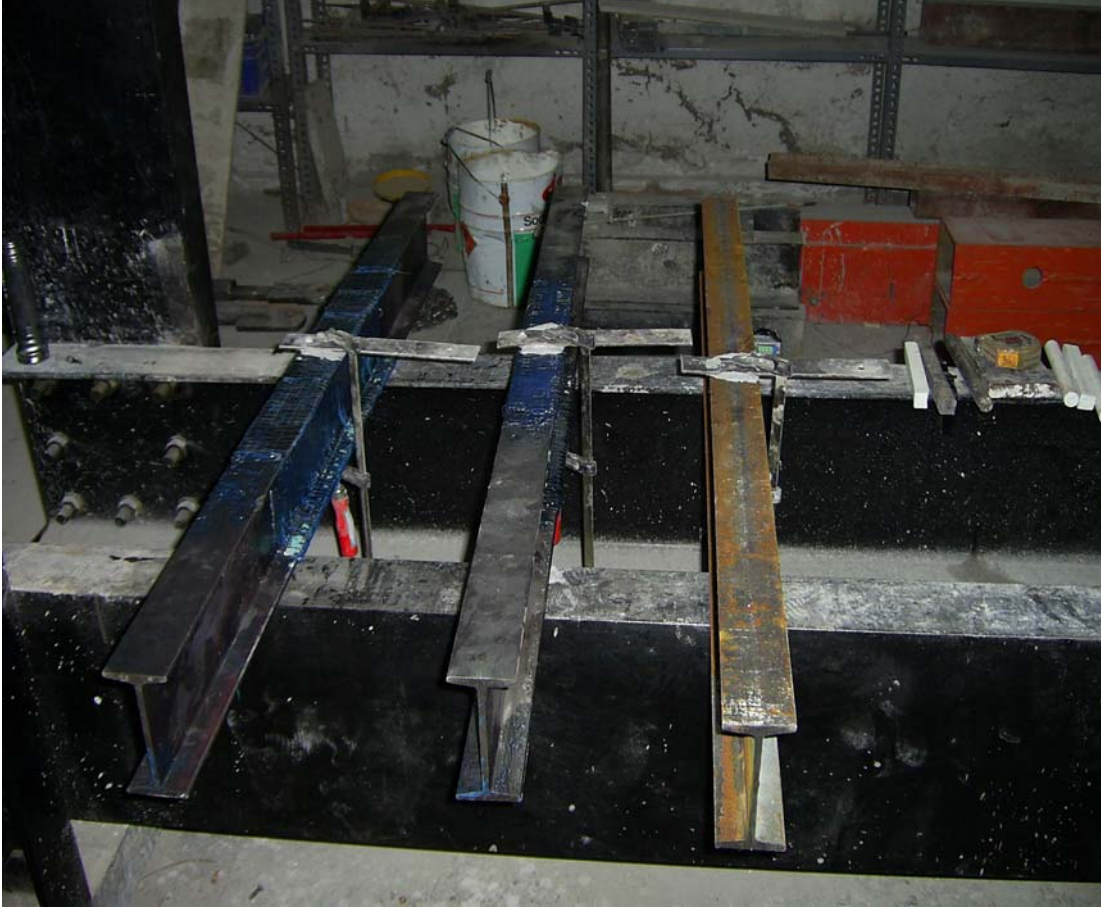
Şekil 3.23. Orta Noktalara Aparatların Yerleştirilmesi
