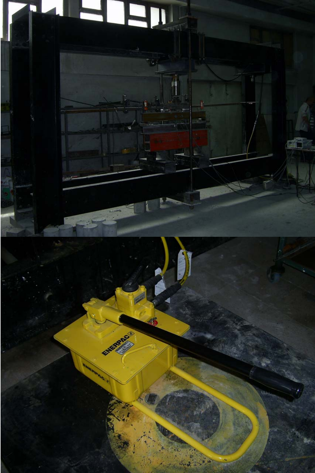
Şekil 3.1. Eğilme Çerçevesi ve Pompası
