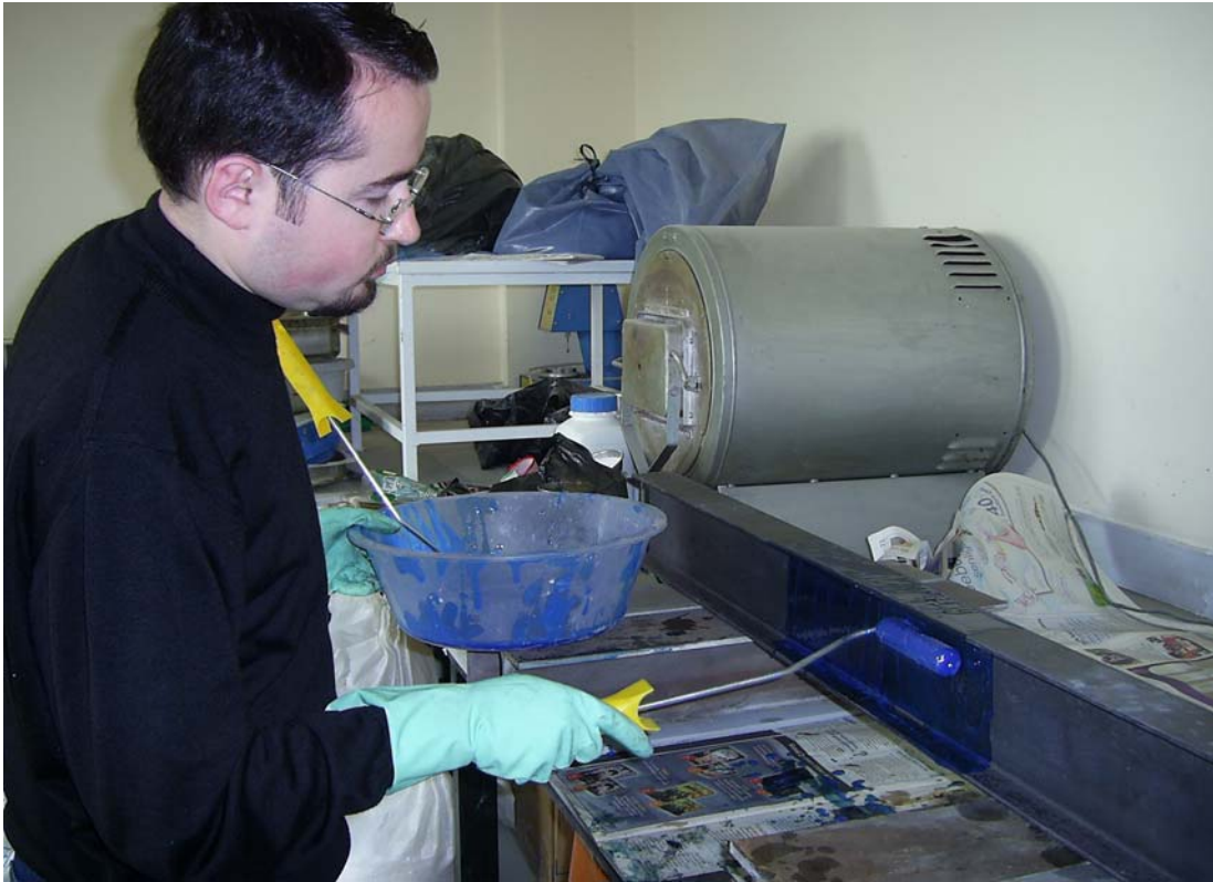
Şekil 3.15. İki Bileşenli Epoksi Esaslı Doyurma Reçinesinin Sürülmesi
