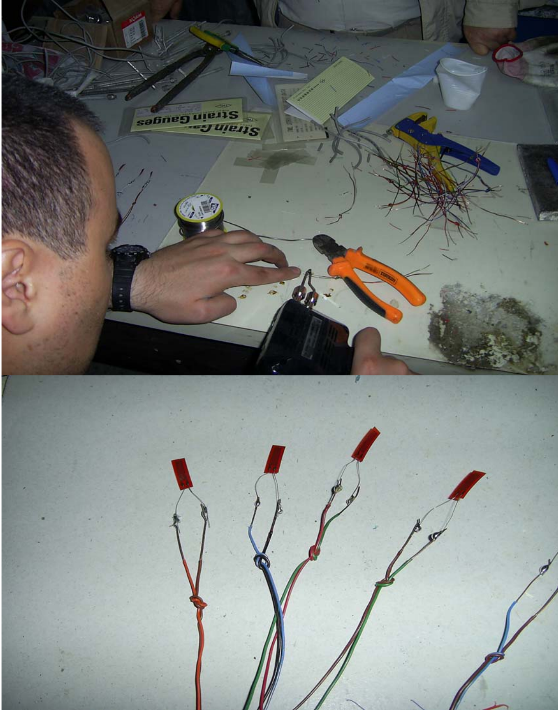
Şekil 3.24. Strain Gaugelerin Lehimlenmesi
