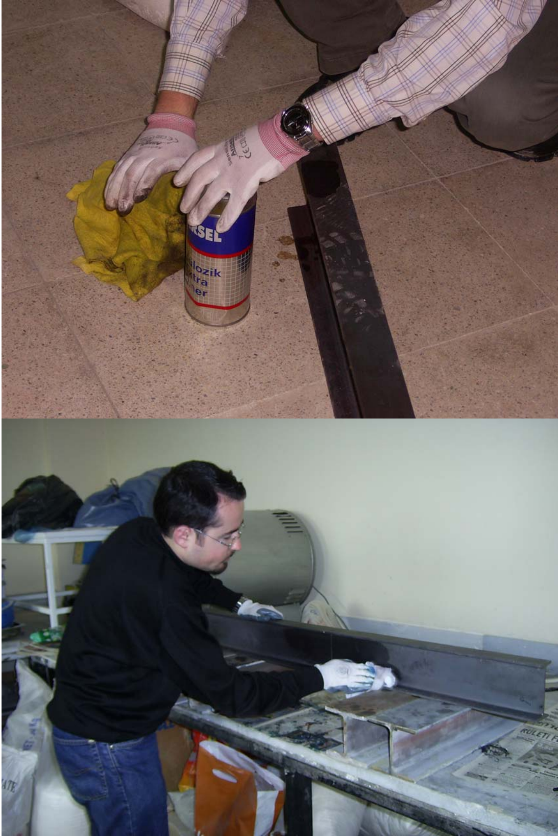
Şekil 3.7. Yüzeyin Tiner Yardımıyla Silinmesi
