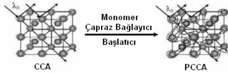
Şekil 2.7. CCA den PCCA oluşumunun monomer, çapraz bağlayıcı ve başlatıcı beraberinde şematik görünümü [21]
