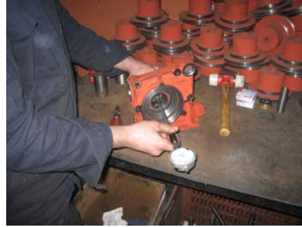
Şekil 1.9b. Delik içi 2. çapın ölçümü
