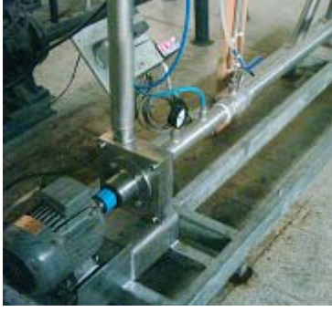
Şekil 1.3 Emme ve basma hatları bağlantıları
