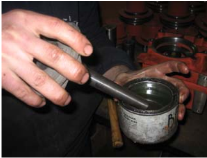
Şekil 1.20a Fan grubunun yağlanması
