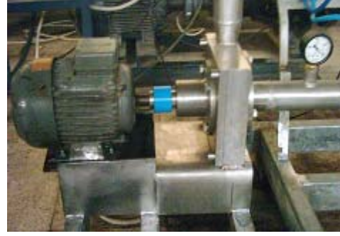
Şekil 1.4 Fan montaj plakası ve motor
