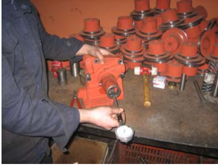
Şekil 1.9a. Delik içi 1. çapın ölçümü
