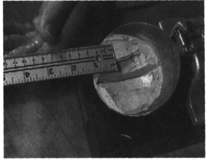
Şekil 3.9: Likit limit için, iki parça arasındaki yivin 13 mm'lik mesafeden kapanması [9]
