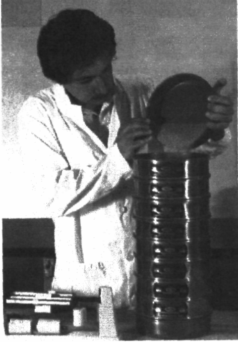
Şekil 3.2. Zemin örneğinin numune tavaşından eleklerle dökülmesi [9]
