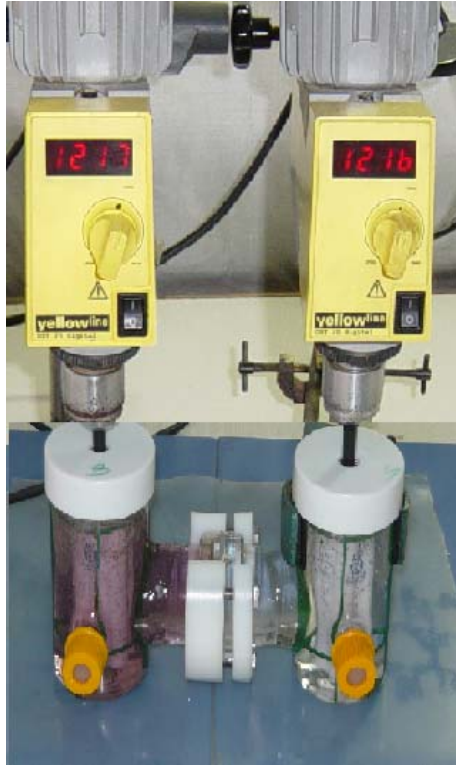
Şekil 4.1. Destekli sıvı membrana ait test hücresinin şematik olarak gösterilmesi (deney başlangıcı)
