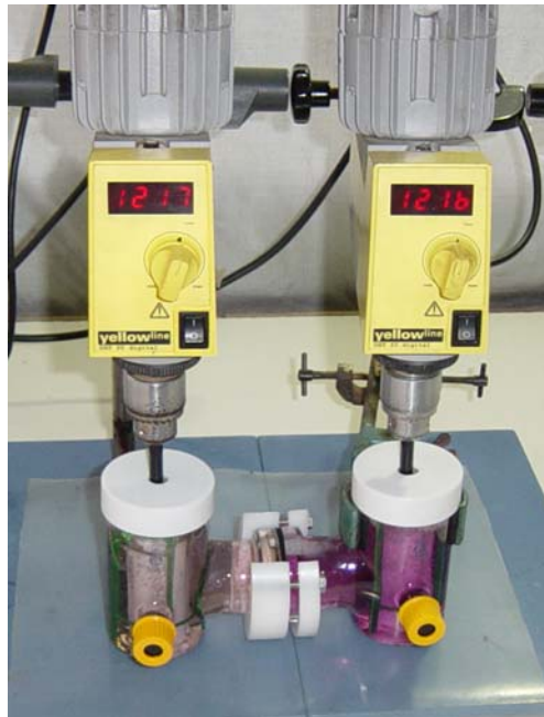
Şekil 4.2. Destekli sıvı membrana ait test hücresinin şematik olarak gösterilmesi (deney sonu)
