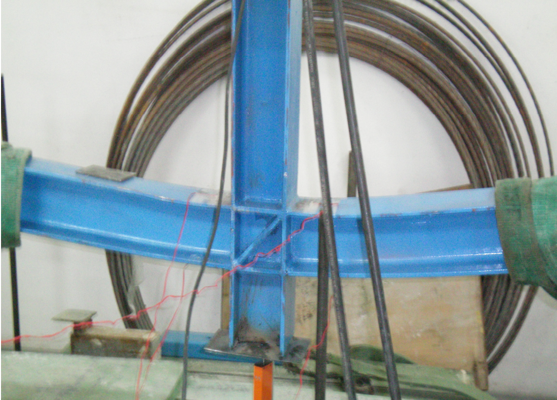
Resim A.29. 4 numaralı deney numunesi řekil deęiřtirmeler
