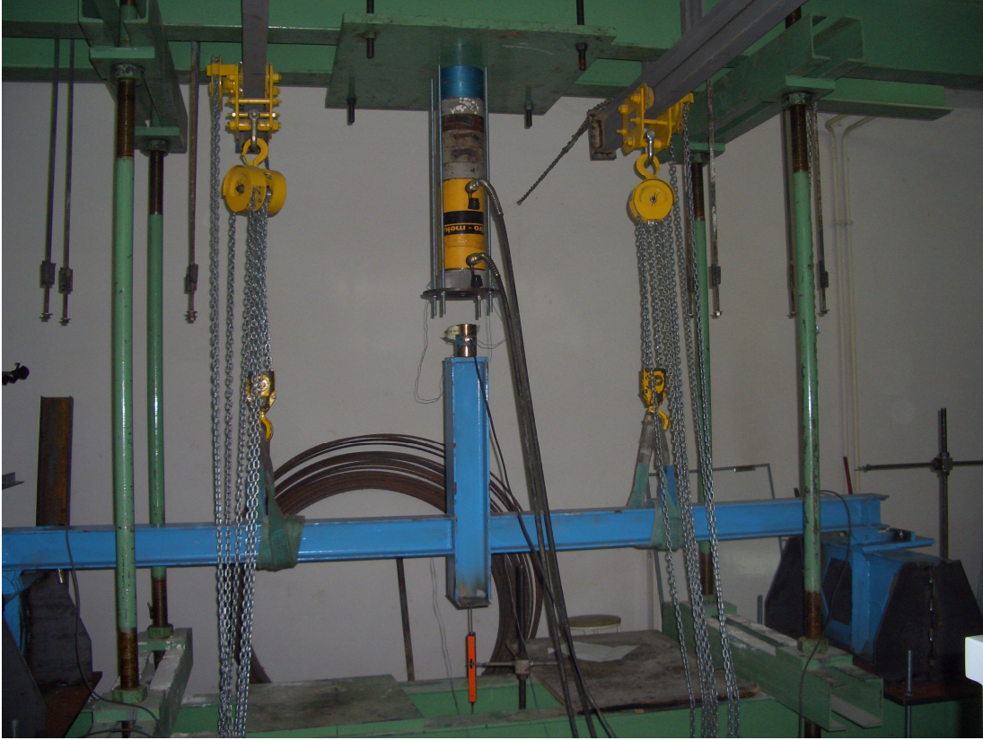
Resim A.14. 1 numaralı deney numunesi çerçeve yerleşimi
