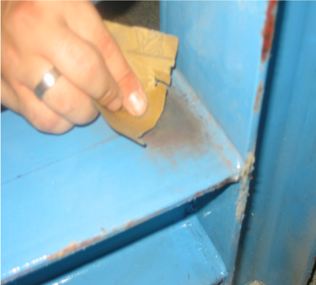
Resim 6.5. Deney numunesinin zımparalanması işlemi
