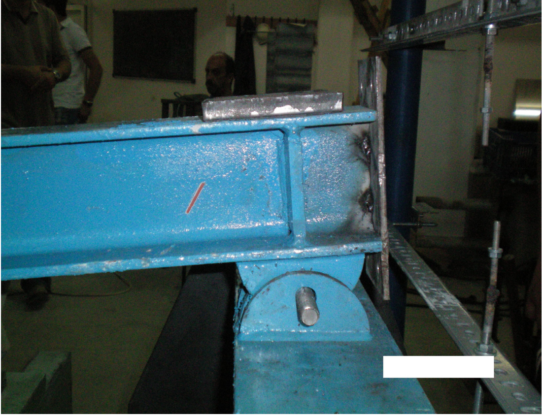
Resim 6.2. Sabit mesnet bölgesi detayı
