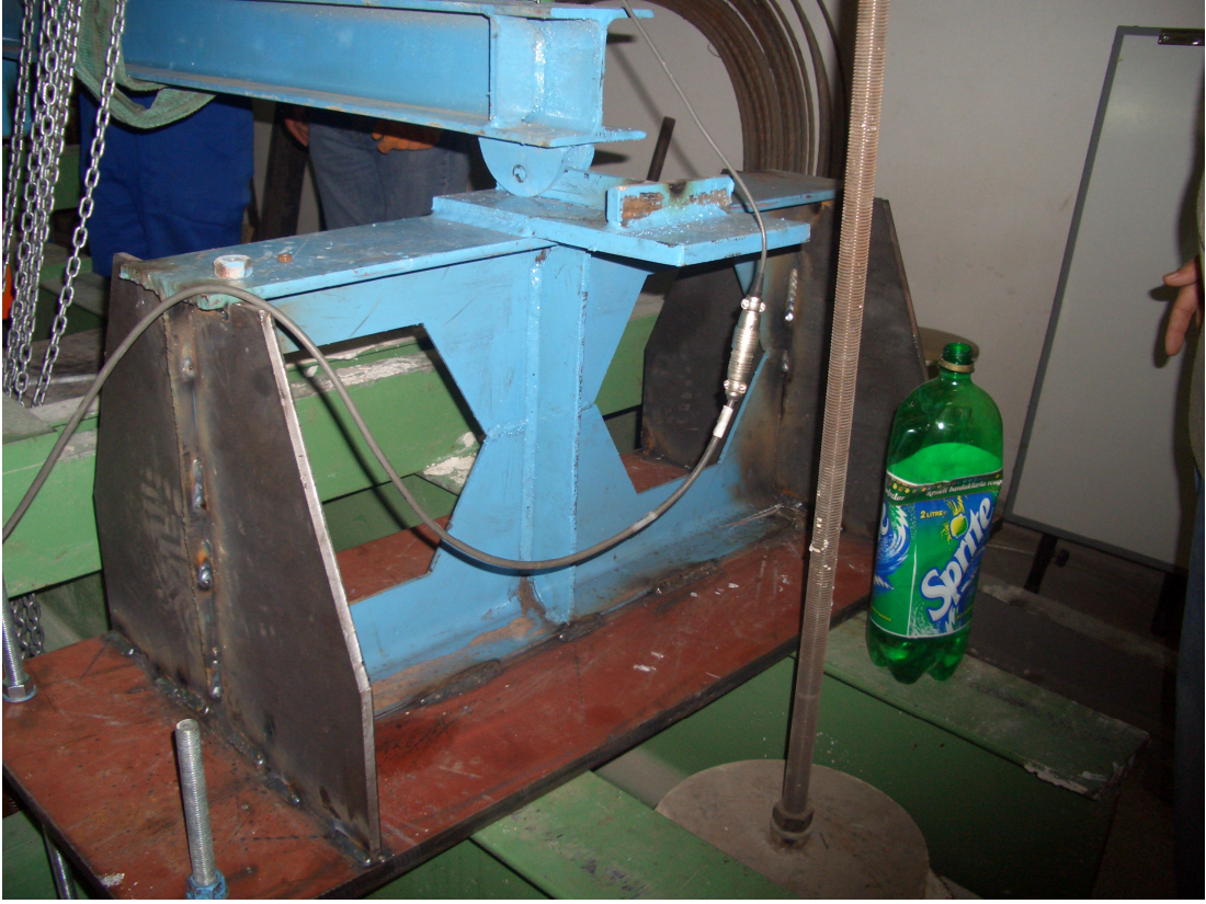
Resim A.10. Hareketli mesnet yerleşimi
