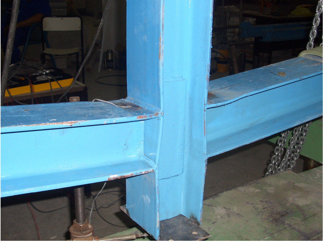
Resim A.18. 2 numaralı deney numunesi için Őekil deęiŐtirmeler
