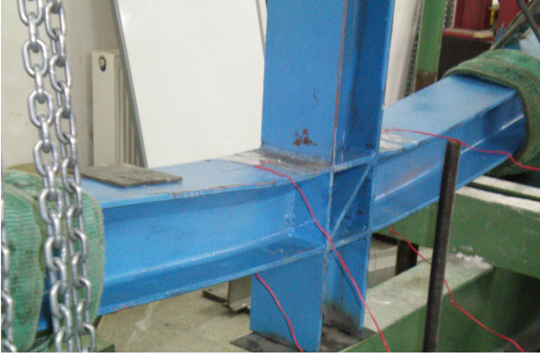
Resim A.28. 4 numaralı deney numunesi řekil deęiřtirmeler
