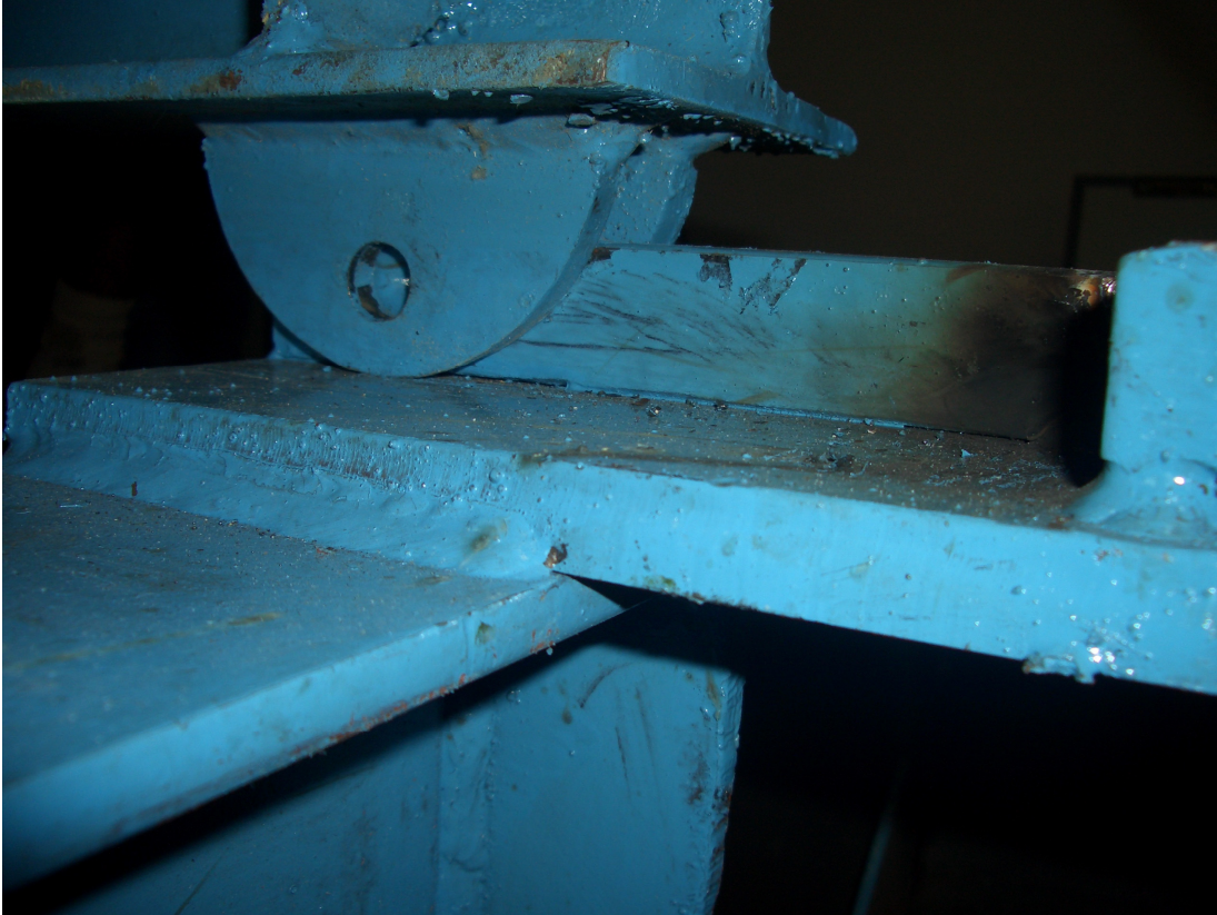
Resim A.9. Hareketli mesnet yerleşimi
