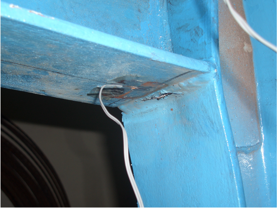
Resim A.20. 2 numaralı deney numunesi kaynak yırtılması
