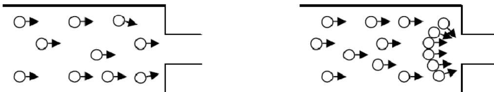
Şekil 2.1. Agregaların kemerlenme oluşturma mekanizması
