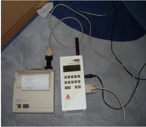
Şekil 4.6. APC Plus BIOTEST Airborne Particle Cunter 942300 model B0504 -1771 tipli Biotest partikül sayım cihazı yazıcısı ile birlikte genel görünümü
