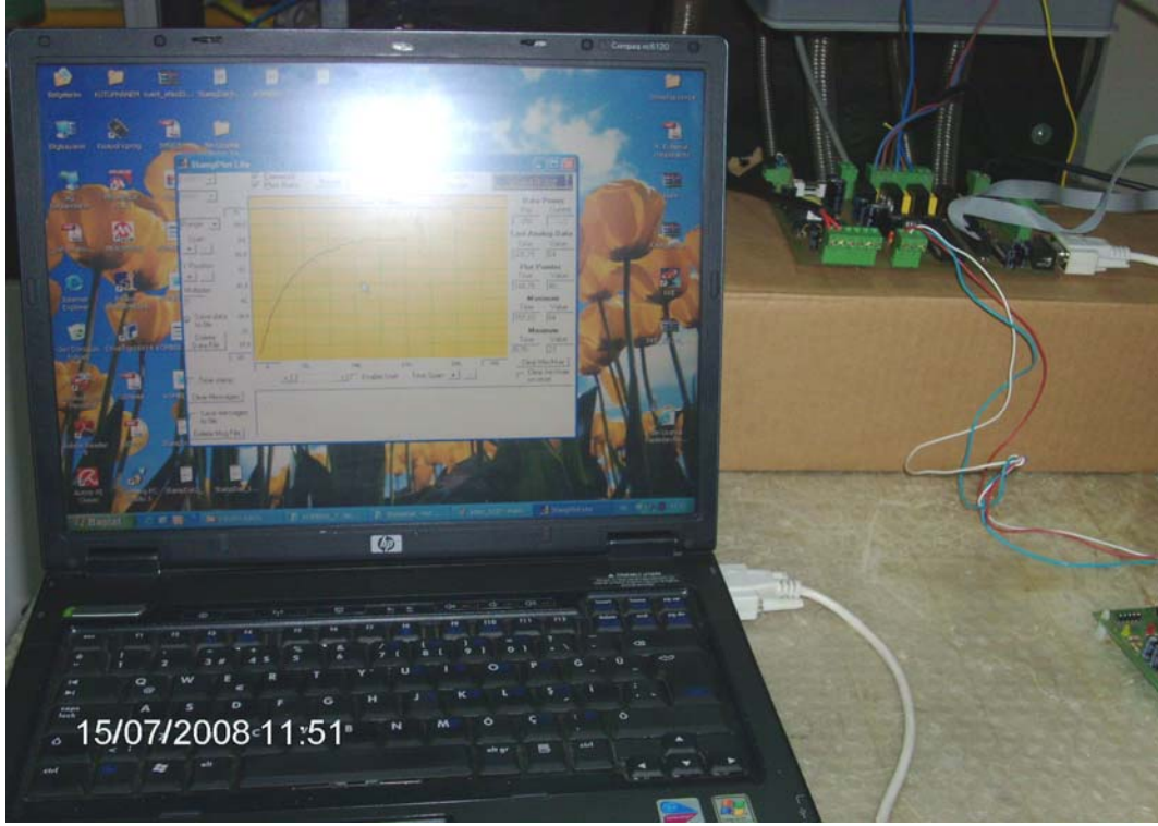
Şekil 7.6. Sıcaklık bilgisinin bilgisayar ortamında takip edilmesi ve değerlendirilmesi
