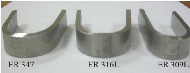
Şekil 5.31. Değişik ilave metaller kullanılarak Argon+%2H 2 atmosferi altında kaynak yapılmış 316L paslanmaz çeliğin eğme deneyi sonuçları
