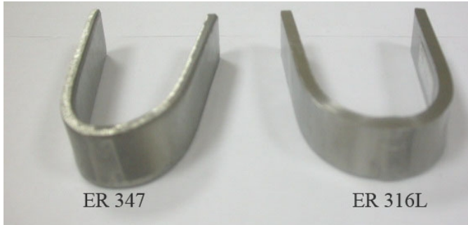
Şekil 5.28. Değişik ilave metaller kullanılarak Argon atmosferi altında kaynak yapılmış 316Ti paslanmaz çeliğin eğme deneyi sonuçları
