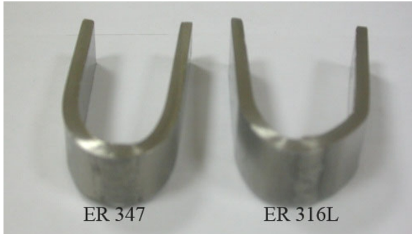
Şekil 5.29. Değişik ilave metaller kullanılarak Argon+%2H 2 atmosferi altında kaynak yapılmış 316Ti paslanmaz çeliğin eğme deneyi sonuçları
