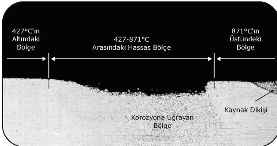
Şekil 3.2. Krom karbür çökeltmesi sonucu hassas bölgede oluşan korozyon [14].
