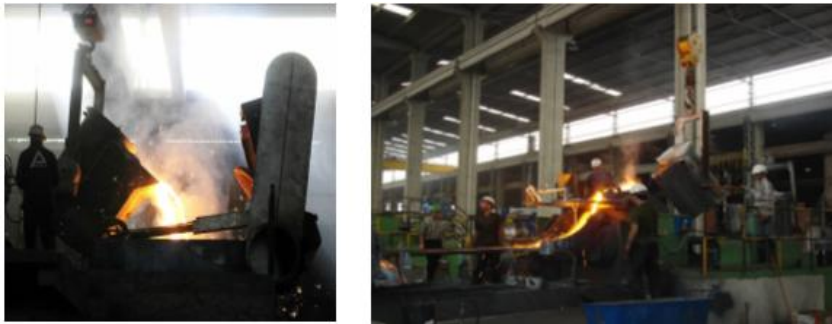
Şekil 4.13. Sıvı alaşıma küreleştirici ilavesi ve sıvının dönen kalıba verilmesi
