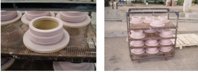
Şekil 4.12. Boru başı mufu için kalıba yerleştirilen reçineli maçalar
