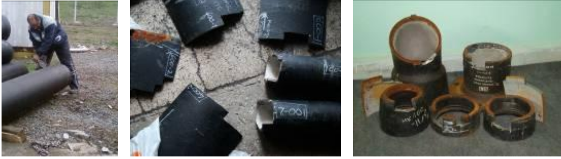
Şekil 5.1. Düktil demir boru ve bağlantı parçası numunelerinin kesilmesi ve kesilmiş örnekler
