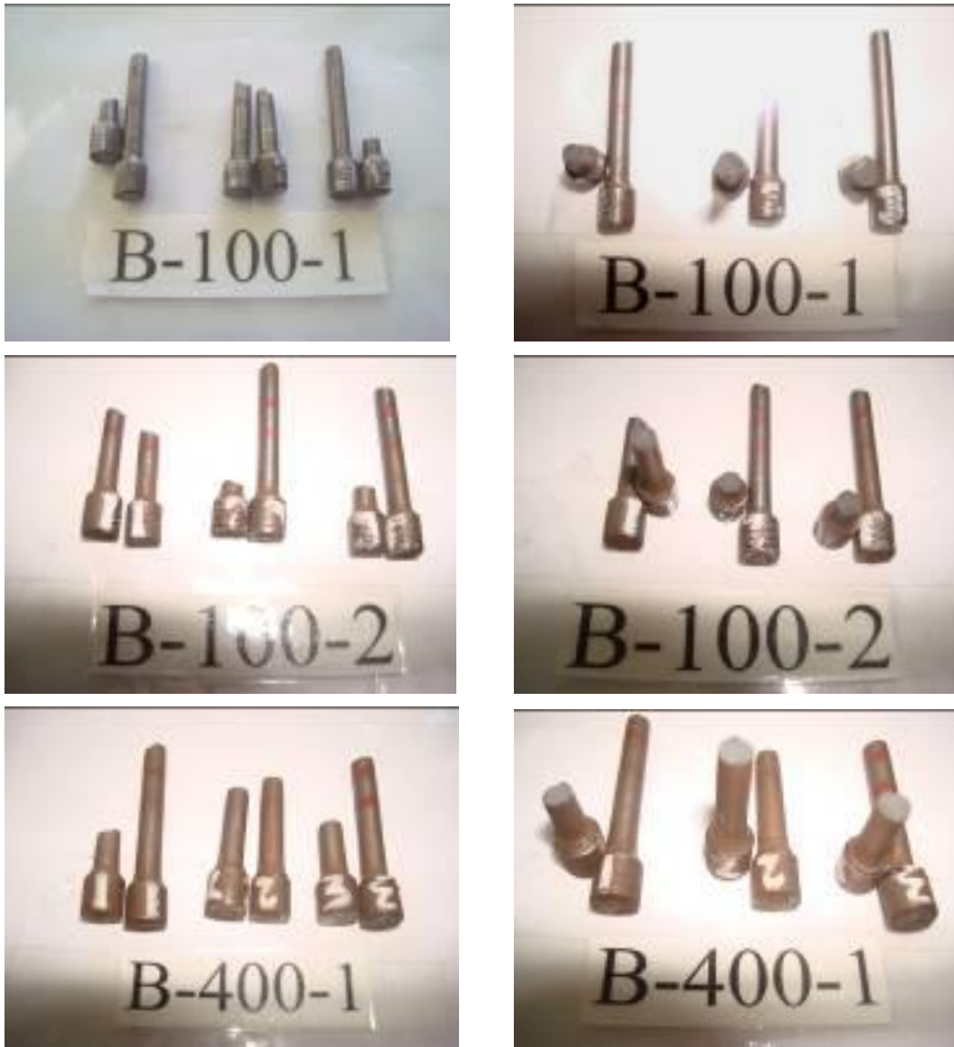
Şekil 6.26. Düktül demir boru numunelerinin çekme testi sonrası resimleri
