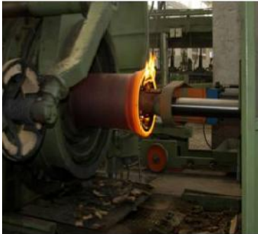
Şekil 4.11. De Lavaud tipi savurma döküm makinesinde üretim aşamaları (şarj, katılaşma, boru sıyırma ve şematik gösterim)
