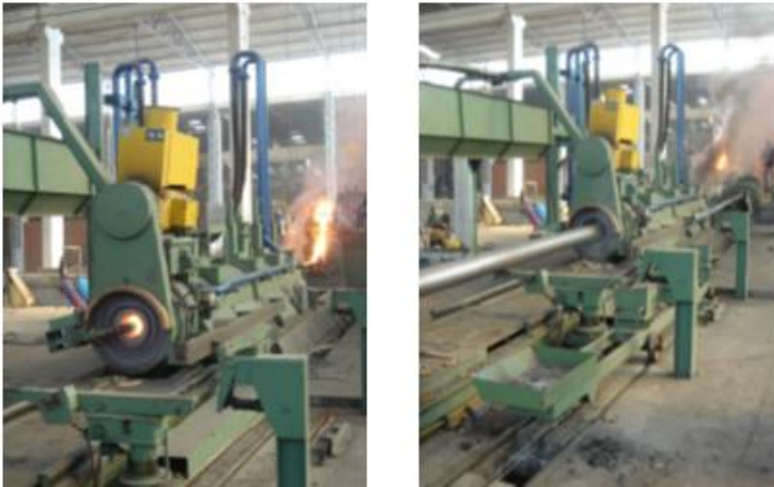
Şekil 4.8. Savurma döküm makinesine sıvı alaşım şarjı ve boru sıyırma
