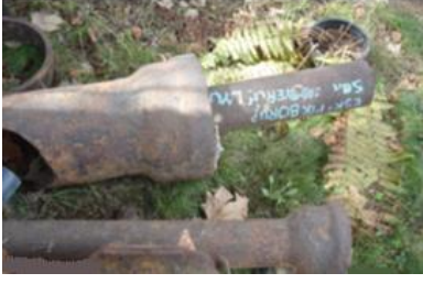
Şekil 4.4. Savurma döküm tekniği ile üretilmiş eski pik borular, Sarıyer
