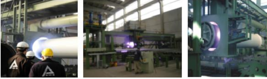
Şekil 4.19. Boru yüzeyine çinko koruyucu kaplama uygulaması
