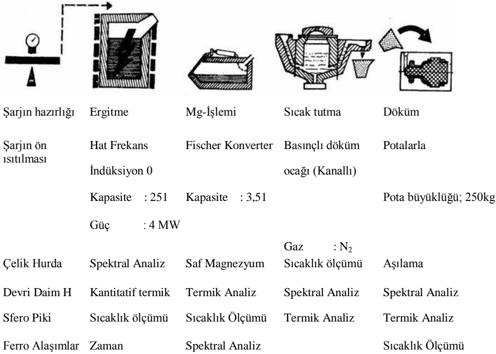
Şekil 3.4. Düktil demir kademeleri ve termik analiz yönteminin uygulanması [11]
