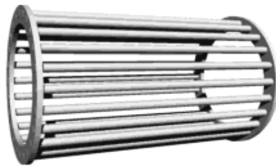
Şekil 3.3. Sincap kafes tipi rotorun içi boş (çekirdeksiz) hali
