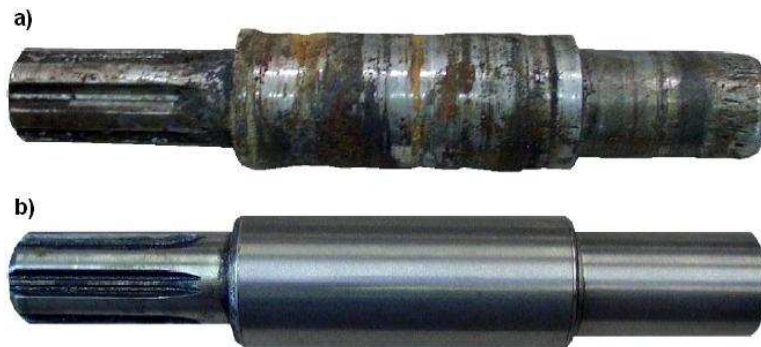
Şekil 3.19. a) İş parçası yüzeyinde kullanım sırasında oluşan aşınma. b) Elektrik ark spreyle kaplanarak tamir edilmiş iş parçası[37].
