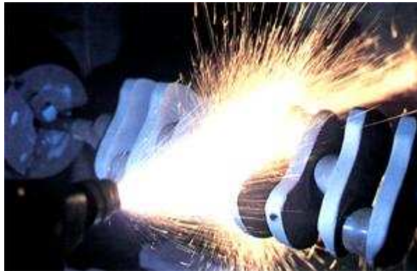
Şekil 3.3. Elektrik ark sprej kaplama örneği[23].
