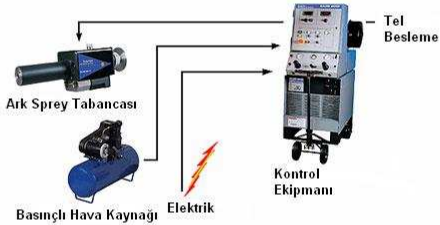
Şekil 3.2. Sistem gereksinimleri ve elektrik ark sprej sistemi[20].
