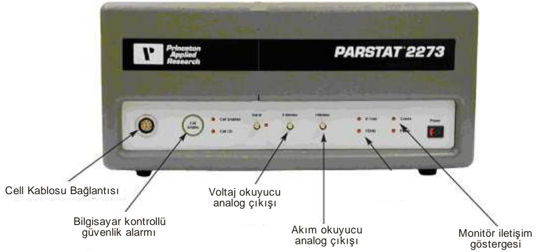
Şekil 4.6. Princeton Applied Research firması tarafından üretilen "PARSTAT 2273" adlı Empedans Analizörünün önden görünümü
