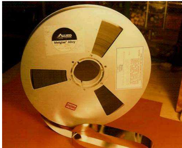
Şekil 4.5. Allied Corporation USA tarafından üretilen Fe 78 Si 9 B 13 metalik cam şeridi
