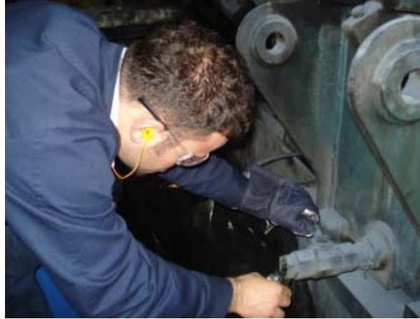
Şekil 3.8. Redüktörden yağ numunesi alınması
