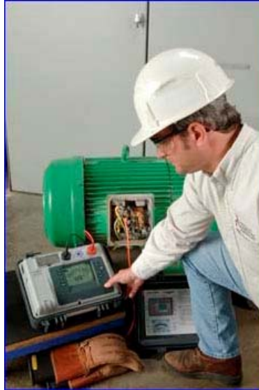
Şekil 3.22. Elektrik motorunda yapılan izolasyon direnci testi
