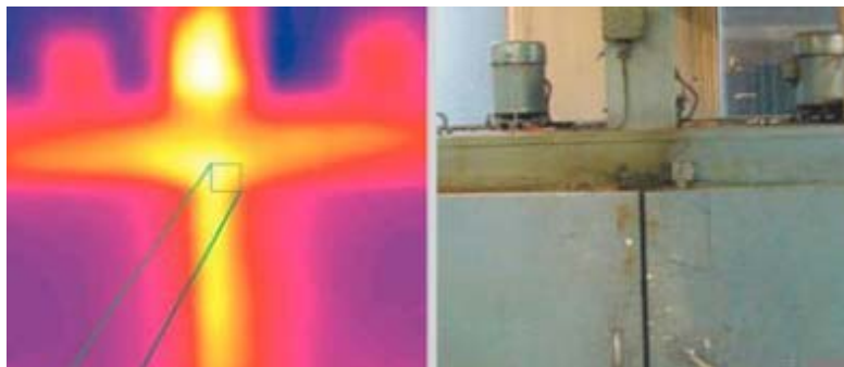
Şekil 2.22. Fırın kapağındaki ısı kaybı
