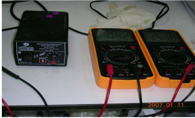
Şekil 5.5. Güç kaynağı, ampermetre ve voltmetre
