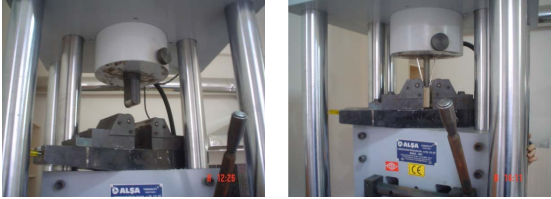
Şekil 4.5. Eğme deney makinesi ve eğilen numune
