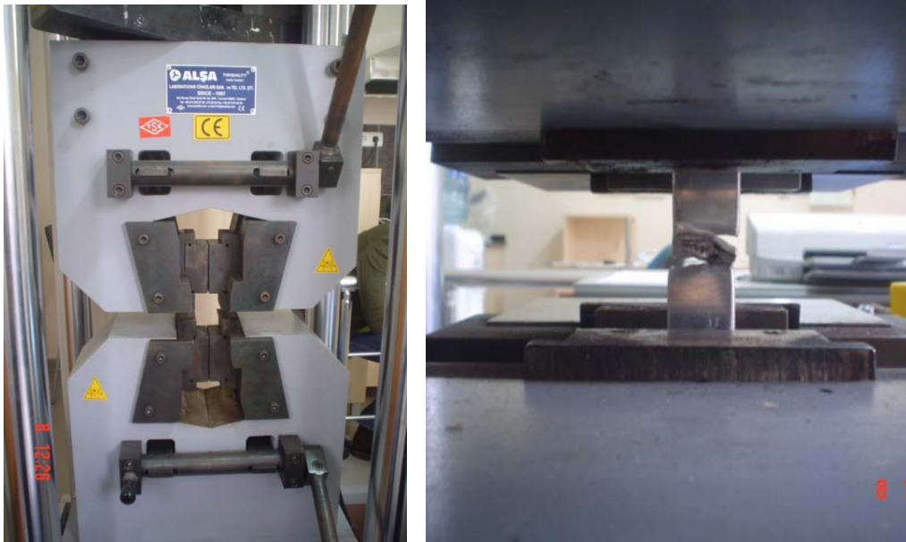
Şekil 4.2. Çekme deneyi makinesi ve çekilen numune
