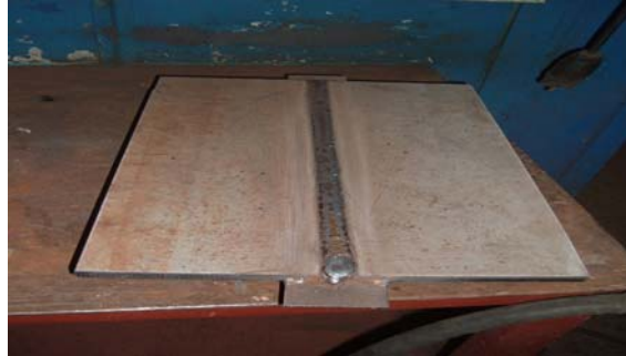
Şekil 7.5. Kaynaklı numunelerin gözle muayenesi
