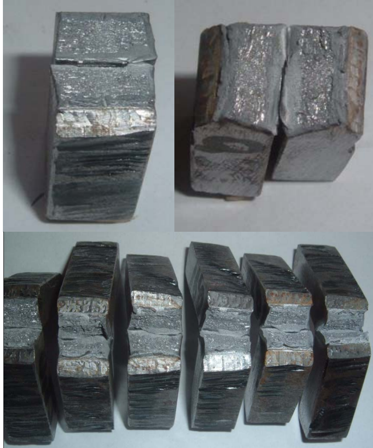
Şekil 8.32. Çentik darbe deney sonrası test parçalarının şekilleri
