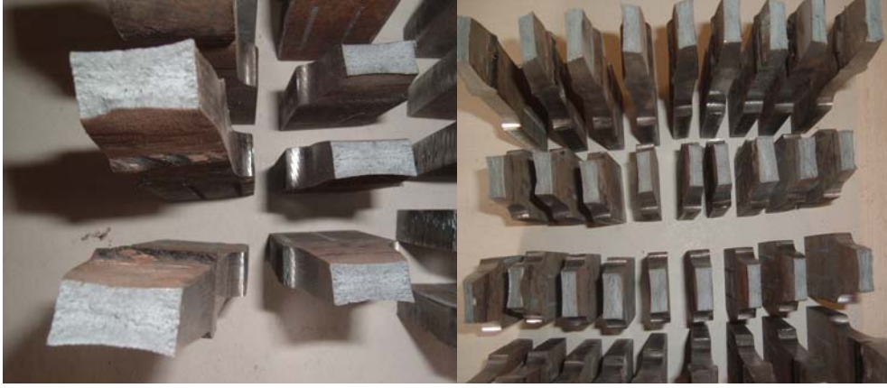
Şekil 8.15. Çekme deneyi sonrasında oluşan kırılmaların sünek kopma biçimleri
