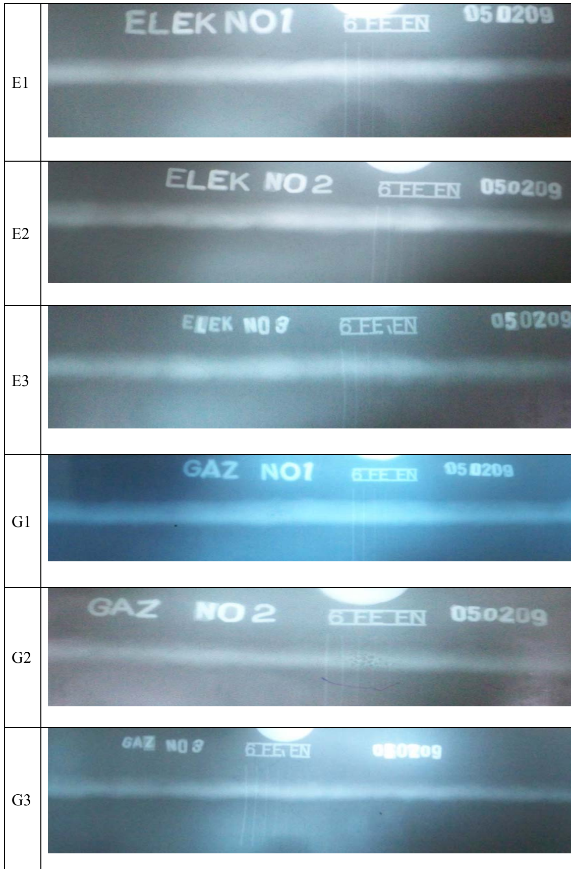
Şekil 7.6. Radyografik yöntemle test numunelerinin filmlerinin görüntüleri.
