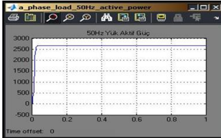
Şekil 5.43. SRYT kontrollü 3-fazlı 4-telli sistemde 50Hz de yükün a-fazından çektiği aktif güç
