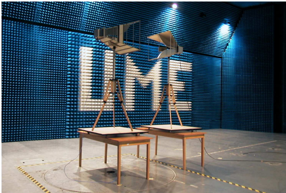
Şekil 2.10. ANSI IEEE 149 standardına göre yarı yansız odada kalibrasyon düzeneği (TÜBİTAK UME' de yapılan bir kalibrasyondan alınmıştır.)
