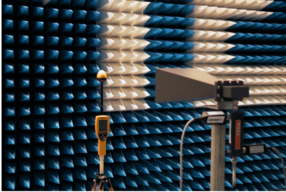
Şekil 2.13. IEEE 1309 standardına göre tam yansısız odadaki kalibrasyon düzeneği (TÜBİTAK UME' de yapılan bir kalibrasyondan alınmıştır)
