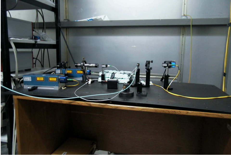
Şekil 4.4. Oda dışında kurulan referans Cs küveti deney düzeneği
