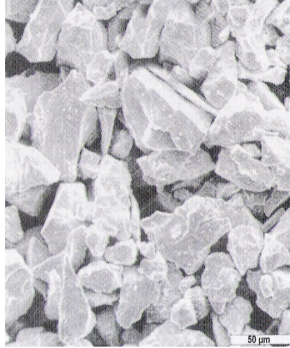
Şekil 2.3. 50 µm boyuta öğütülmüş niyobyum tozlarının taramalı elektron mikroskop görüntüsü [12]
