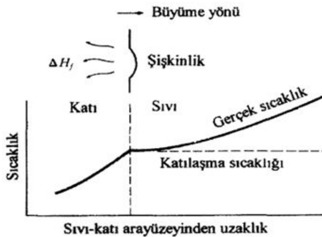
Şekil 2.8. Düzlemsel büyümenin oluşumu [8]
