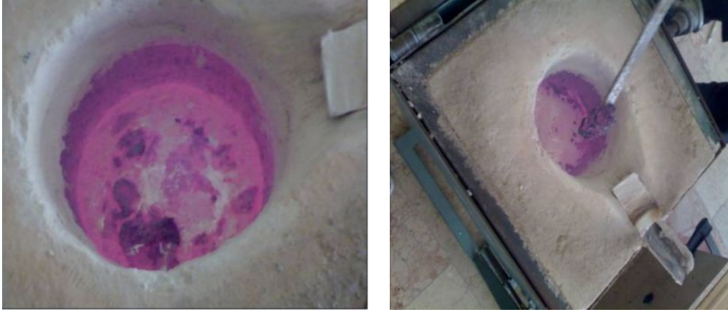
Şekil 3.12.(a) Ergiyik içinde curufların toplanması, (b) Curuf alma işlemi
