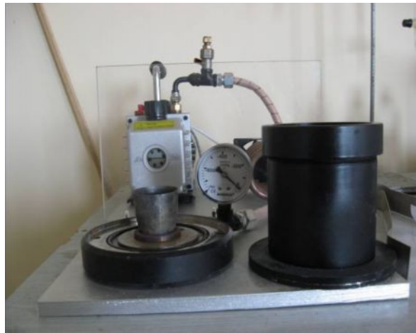
Şekil 3.3. RPT gazlılık ölçüm cihazı
