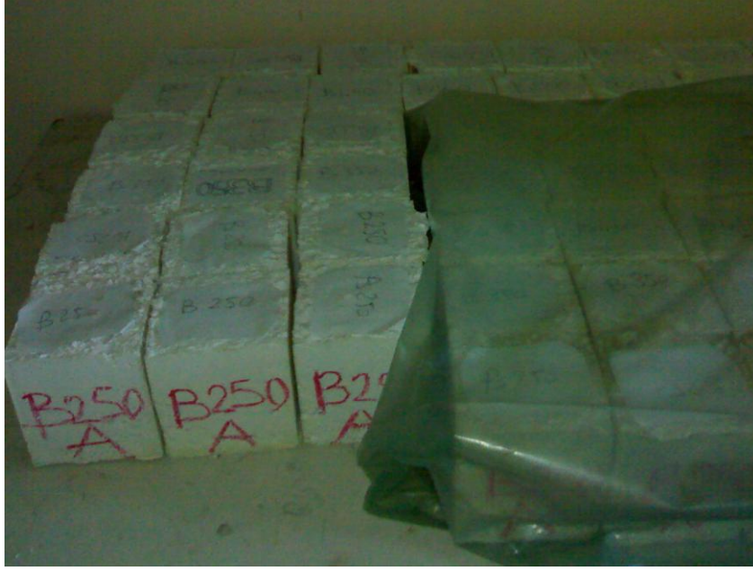
Şekil 2.2. Laboratuvar ortamında naylon örtüye sarılı ve açık olarak bulunan beyaz betonlar
