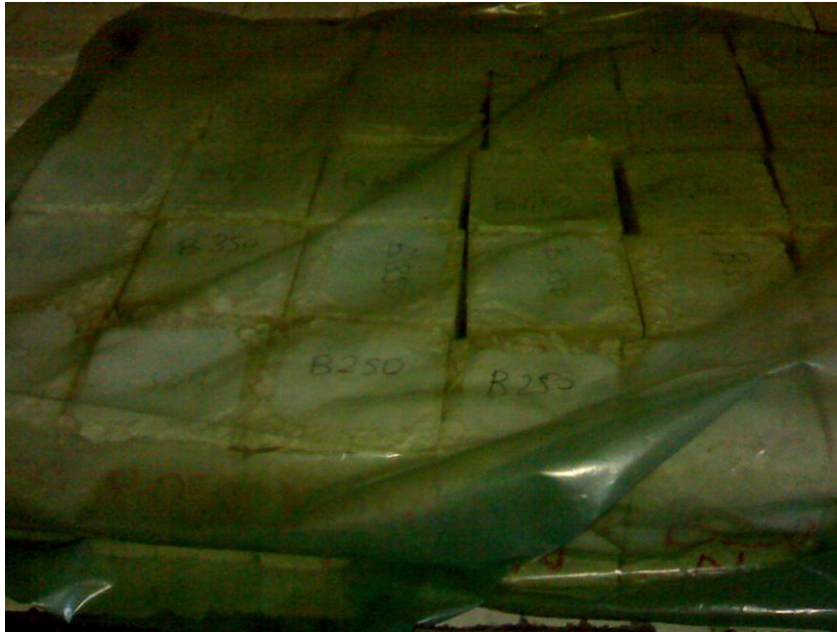
Şekil 2.3. Üretilen beyaz betonlara uygulanan naylon kürü yöntemi
