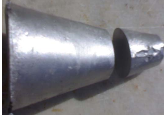
Şekil 3.8. Kesilmiş tane inceltme külçesi
