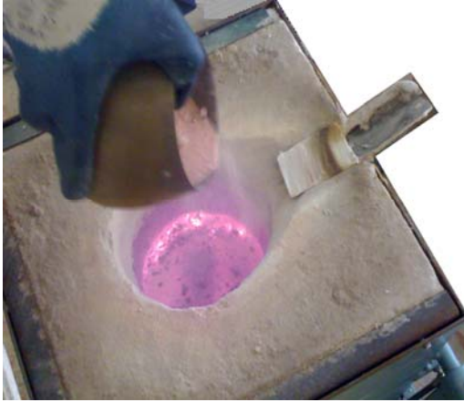
Şekil 3.16. Sıvı Metale Curuflaştırıcı toz Atılması
