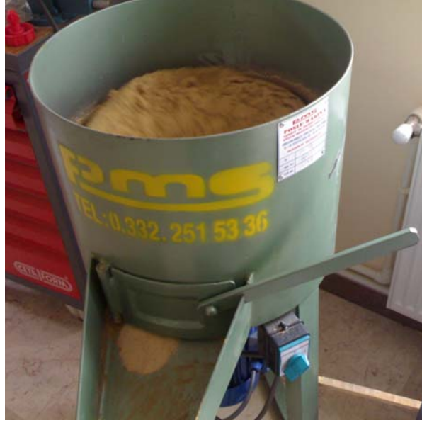
Şekil 3.12. Karıştırma mikserinde kumun hazırlanması
