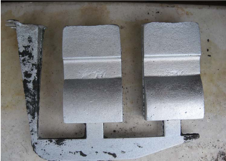
4.13. Döküm parçanın kalıptan çıkmış hali
