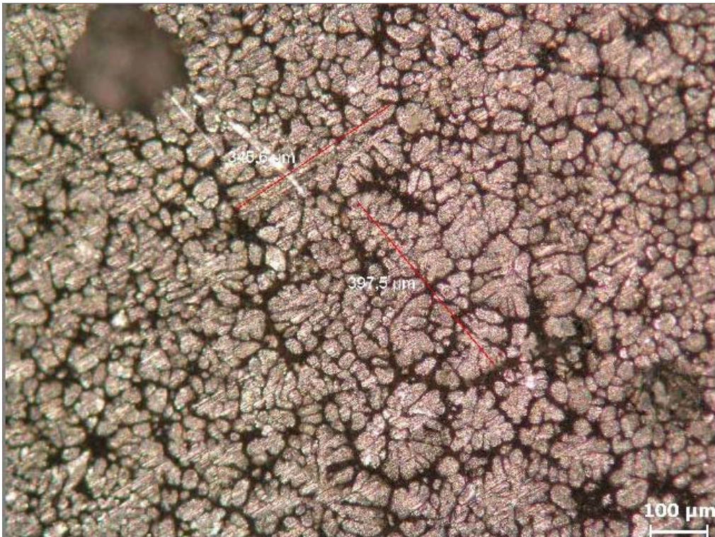
Şekil 4.4b. Al5Ti1B ilavesinden 15 dakika sonra (ölçülü)
