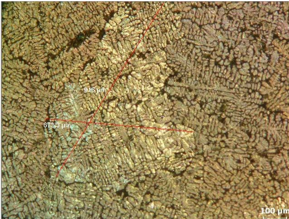
Şekil 4.2b. Al 5 Ti 1 B ilavesinden 5 dakika sonra (ölçülü)
