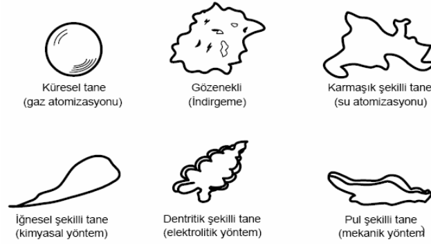
Şekil 2.12. Toz üretim yöntemine göre tane şekillerinin değişimi [31].
