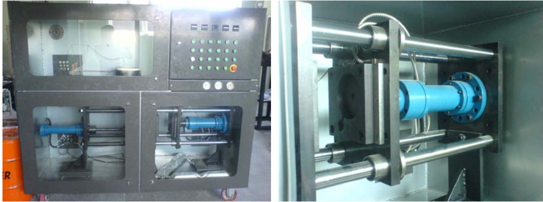
Şekil 4.1. Sıkıştırma Döküm sistemi
