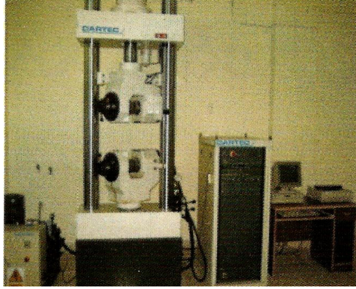
Şekil 4.7. DARTEC M100/RF2+600 kN kapasiteli çekme cihazı
