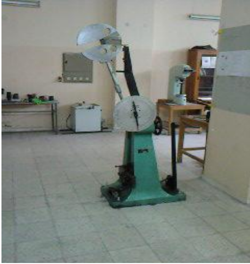
Şekil 4.11. a) Çentik darbe cihazı
