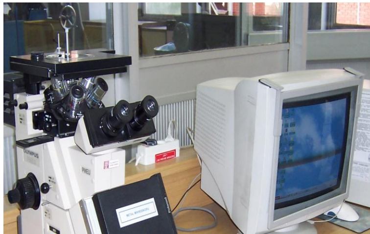
Şekil 4.12. Mikroyapı tespitlerinde kullanılan optik mikroskopi (Olympus PME 3)
