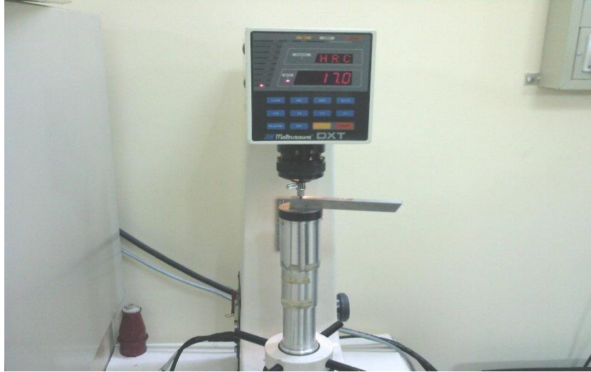
Şekil 4.9. MATSUZAWA DXT-3 Rockwell sertlik ölçüm cihazı
