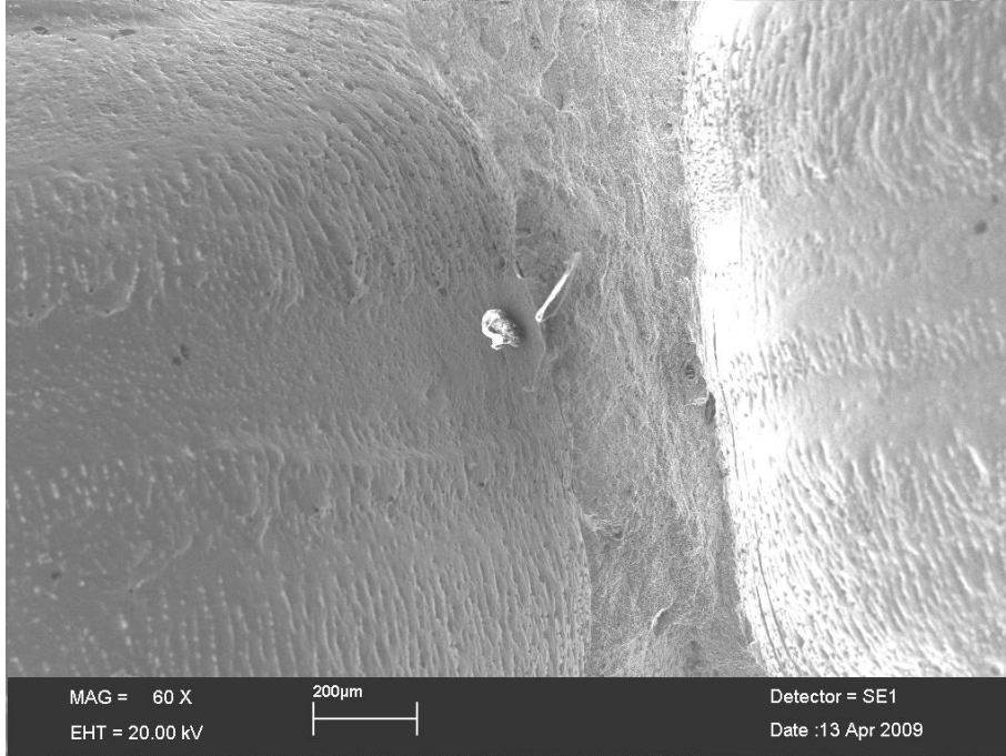
Şekil 5.52. Elektrik Ark kaynaklı numunenin çekme deneyi sonrası kırık yüzeyinin SEM mikrografi. Kaynak hatalarından dolayı düşük mukavemet değerleri bulunmuştur.
