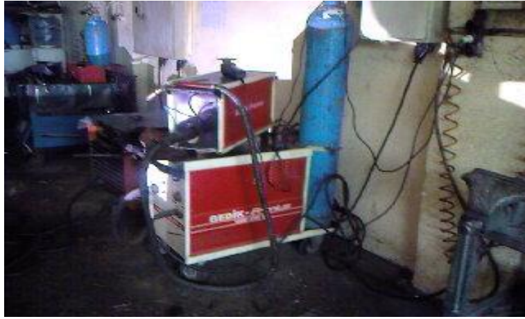
Şekil 4.5. MIG/MAG kaynağında kullanılan GKM 420-G kaynak makinesi
