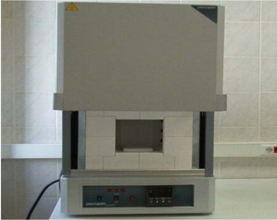
Şekil 3.2. Kalsinasyon işleminde kullanılan kamara tipi küp fırın
