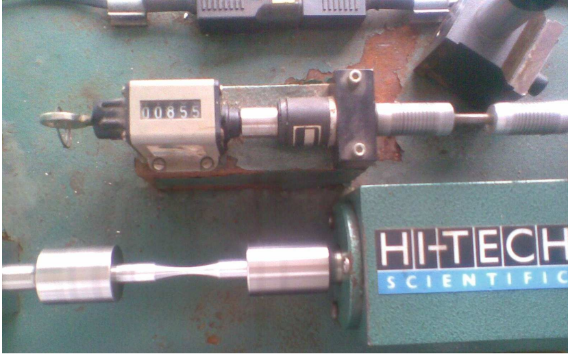
Şekil 5.4. Deney parçasının bağlanması ve çevrim sayacı
