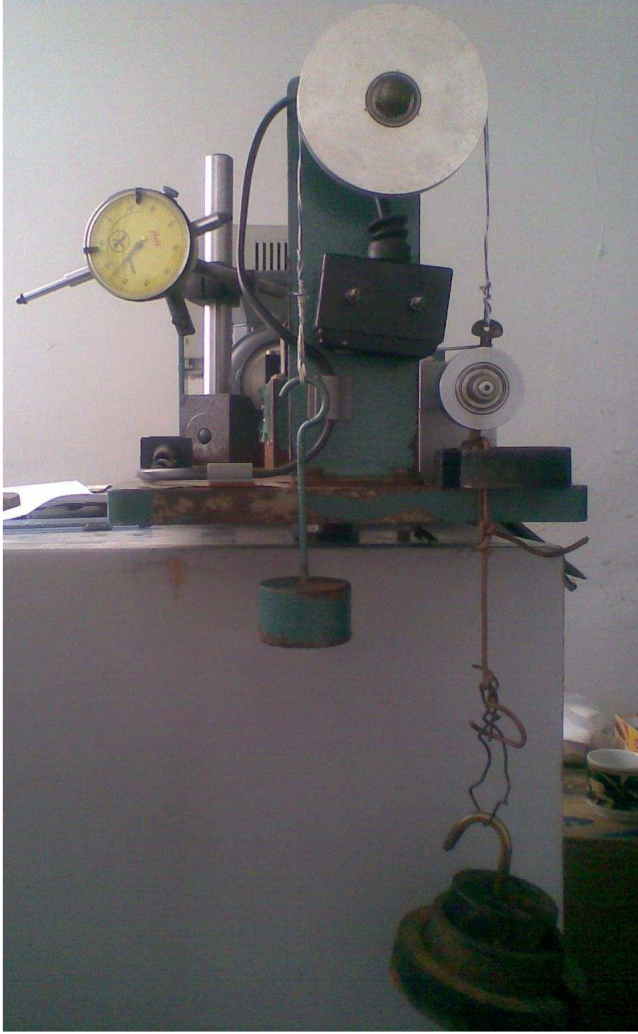
Şekil 5.5. Karşı ağırlıkların yorulma deney düzeneğine bağlanması
