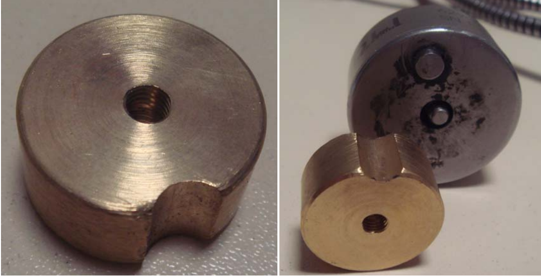
Şekil 4.3. Rondelanın fotoğrafı ve ivme algılayıcı ile birlikte görünümü
