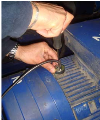
Şekil 4.26. İvme ölçerin ölçüm rondelasına bağlanması
