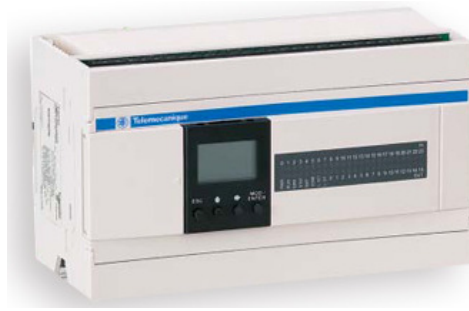
Şekil 4.5. Sistemde kullanılan kontrolör (PLC) görünümü
