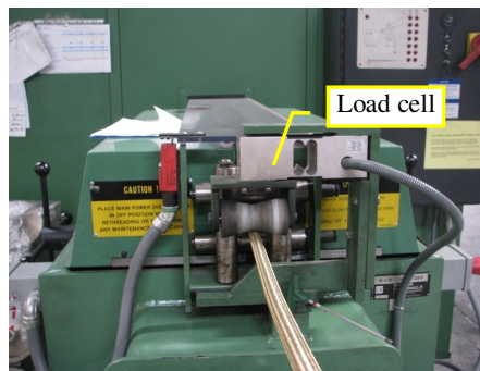
Şekil 2.2. Sistemde kullanılan yük hücresinin yerleşim resmi
