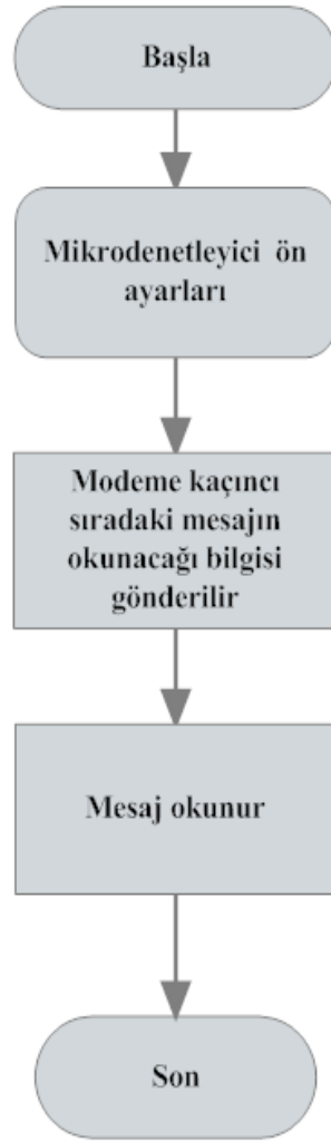
Şekil 5.4. Mikrodenetleyici ile cep telefonundan mesaj okunması programı akış diyagramı
