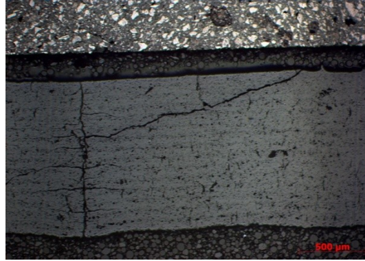
Şekil 5.39 Triplex mullit kaplamanın 50 saat sonrası kesit görüntüsü (5x)
