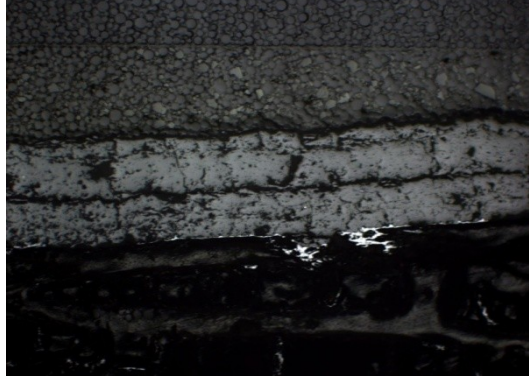
Şekil 5.29 3MB ile C/C+SiC üzerine mullit kaplamanın 5 saat fırın sonrası görüntüsü (5x)
