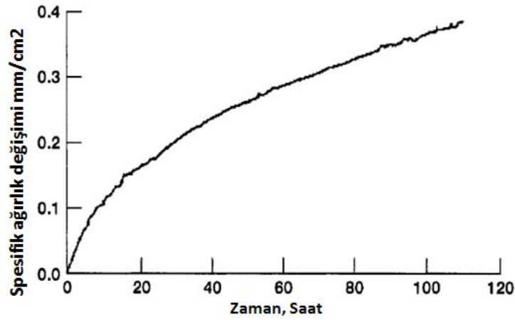
Şekil 3.4 Silisyum karbürün zamana bağlı oksit kalınlığındaki artışı [23]
