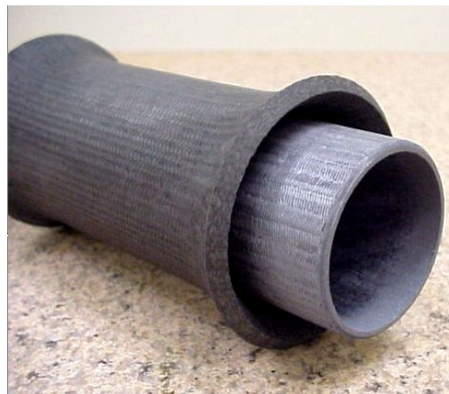
Şekil 3. 3 NASA tarafından yanma odası için geliştirilen soğutmasız C/SiC kompozit malzeme [19]
