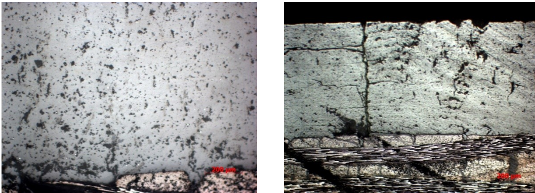
Şekil 5. 18 Kırkbeşinci çevrimde hasara uğrayan mullit kaplamanın a) çevrim öncesi b) çevrim sonrası görüntüleri
