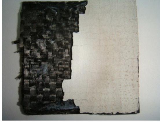
Şekil 5. 16 Kırkbeş çevrim sonrası Triplex mullit kaplamanın görüntüsü
