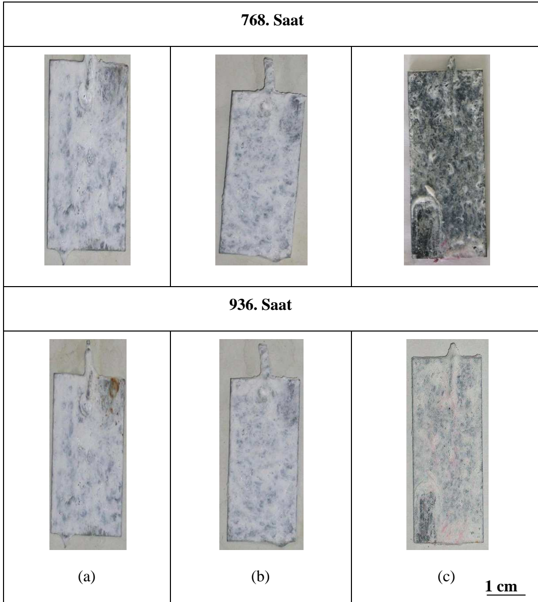
Şekil 5.35 7140K çelik numunelerinin 768 ve 936 saatlik tuz püskürtme testi sonrası makro görüntüleri. (a)Zn+0,5Al+0,1Cu, (b)Zn+0,5Al ve (c)Zn+%0,1Cu
