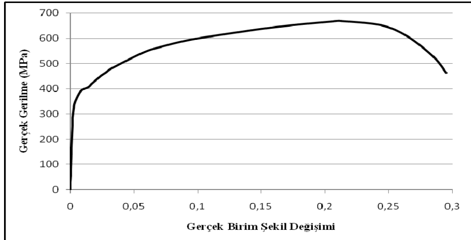
Şekil 5.16. 42CrMo4 çeliği için gerçek gerilme-gerçek b.ş.d. eğrisi
