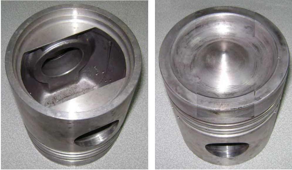
Şekil 4.5. MVM 518 TBRHS V 16 Dizel motor pistonu
