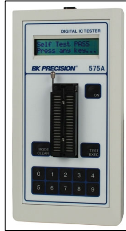
Şekil 3.1. BK Precision 575A dijital entegre test cihazı
