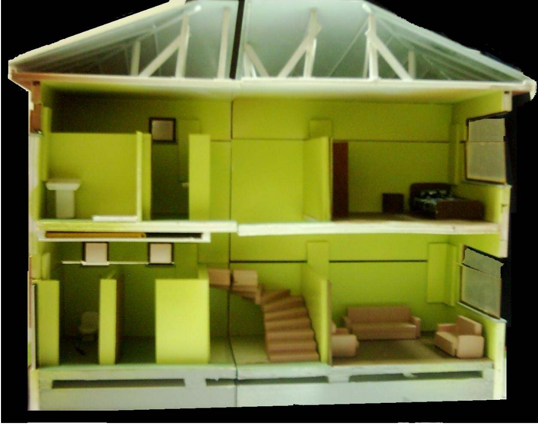
Şekil 4.4. Deney Grubu İçin Hazırlanan Maketin B-B Kesit Görüntüsü
