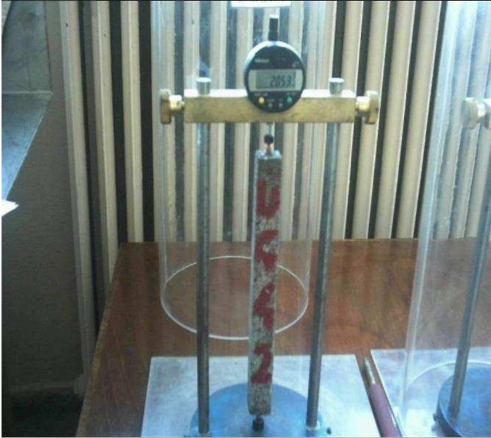
Şekil 4.5. Dijital komparatör ile örneklerin boy ölçümü
